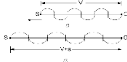
Gambar 3. Bentuk Gelombang Sumber Bunyi Menjauhi Pendengar Yang Diam
