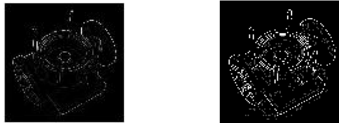
(a) Tepian setelah Penghapusan Non Maksimum (b). Thresholding Ganda Gambar 6. Edge Thresholding
