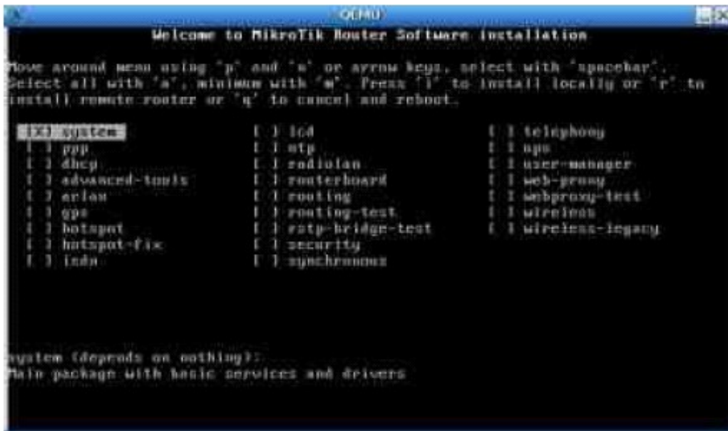
Gambar 7. Paket instalasi mikrotik
